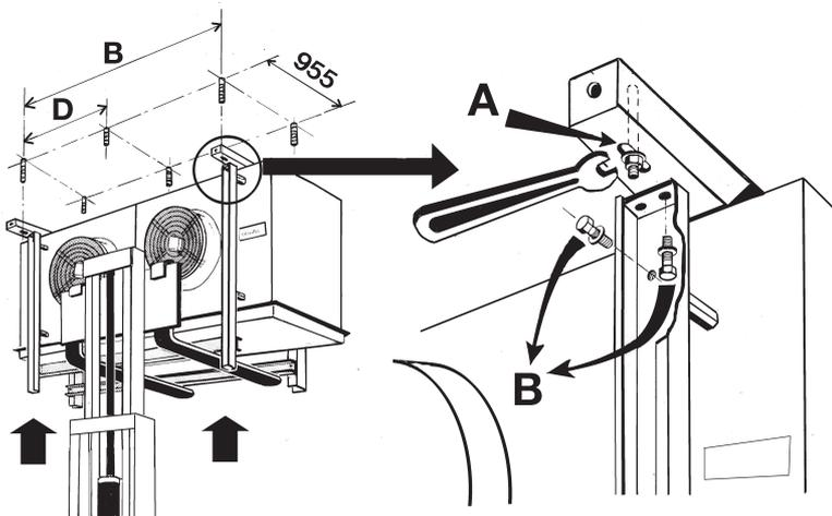
**Installazione a soffitto** Sollevare la cassa al soffitto usando un carrello a forche facendo passare negli appositi fori i tiranti di sostegno. Bloccare i dadi dei tiranti di sostegno "A" interponendo una rondella di bloccaggio. Togliere i bulloni "B". Abbassare la cassa.
