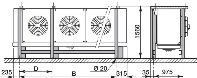
**Installazione a pavimento** Gli aerorevaporatori HIL-HILA-HILW sono forniti con una struttura da usare per il montaggio a soffitto. La stessa struttura è utilizzabile per l'installazione a pavimento.
