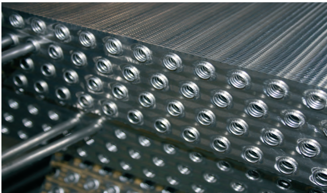
Una fase di assemblaggio batteria di raffreddamento in LU-VE, Uboldo, Varese.
