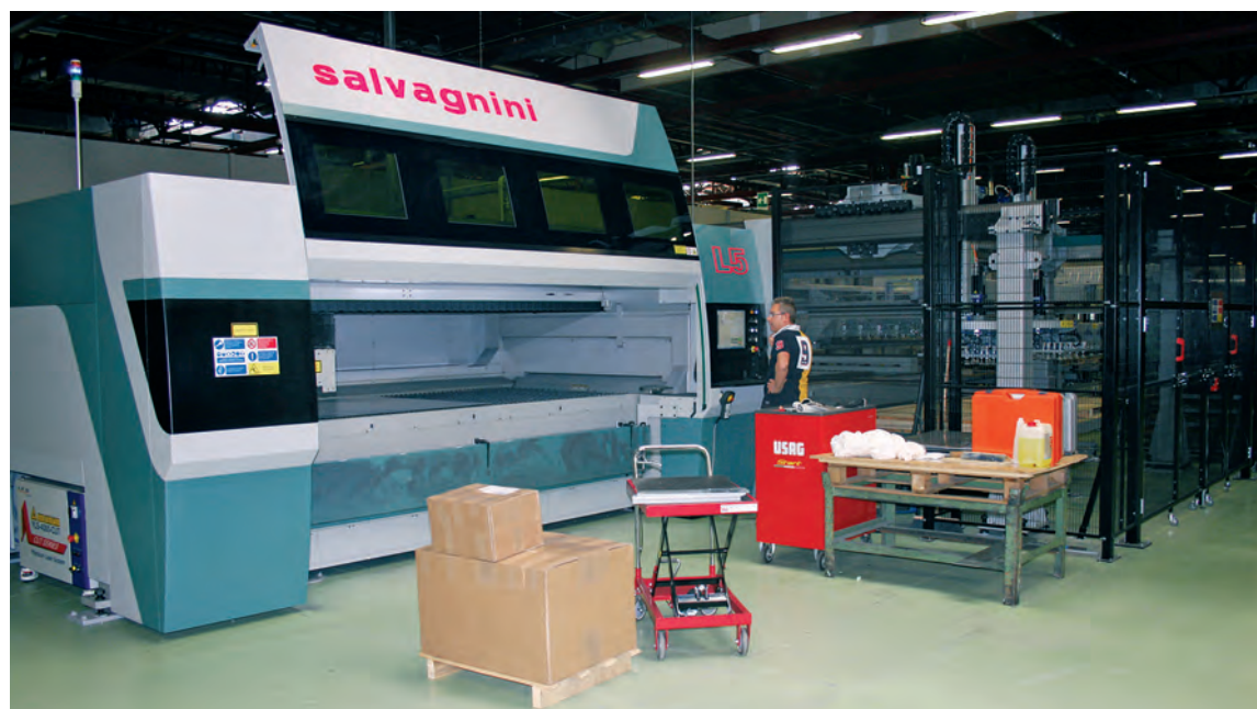
Il sistema di taglio con laser in fibra L5 Fiber di Salvagnini.
