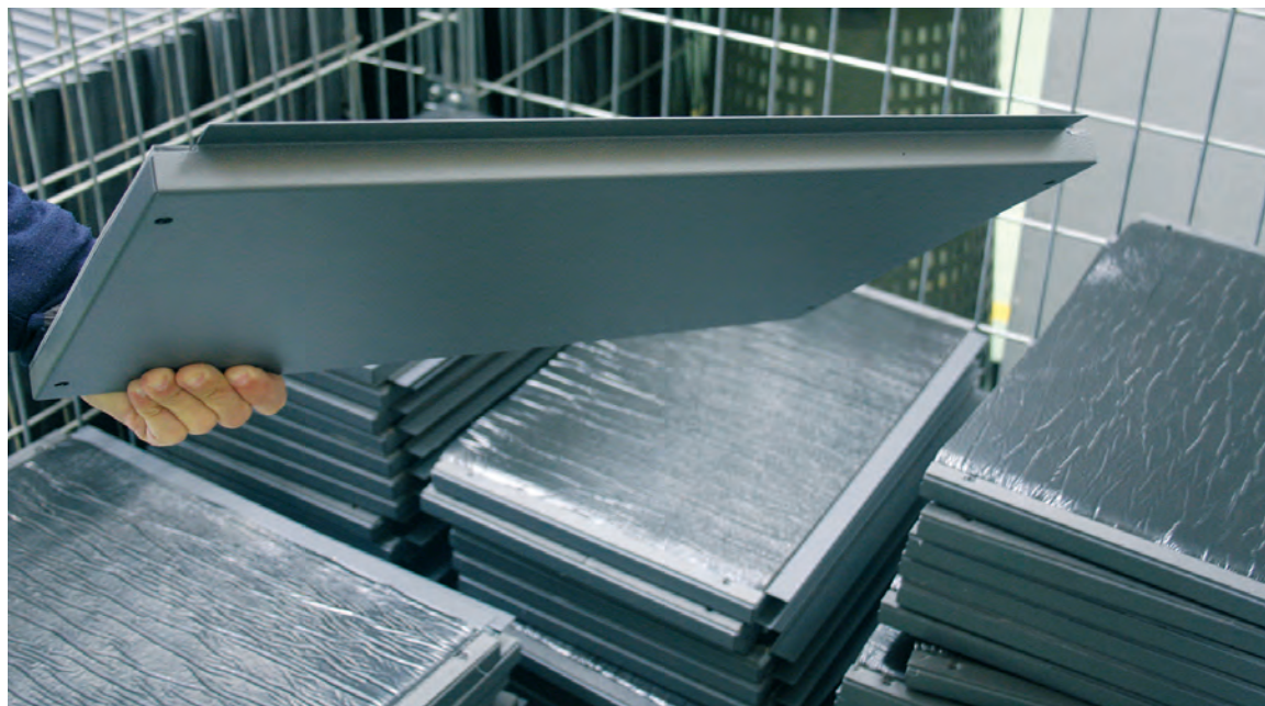
La pannellatrice P2lean integrata nella cella è utilizzata anche nel caso di semplici pannelli con quattro pieghe e ciò è dovuto alla semplicità e alla velocità di programmazione.
